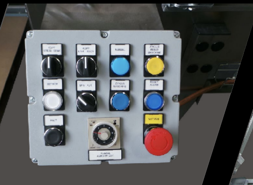
-Pulsantiera per avvio automatico ciclo di presa/scarico -Painel de controlo para início automático do ciclo de carga/descarga
