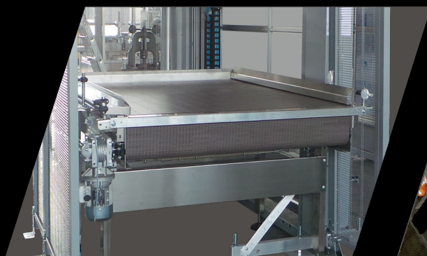
-Banco di accumulo inox con capacità, 1,5 strati di bottiglie (di serie), 2 strati di bottiglie, 3 strati di bottiglie -Banco de acumulação inox com capacidade, 1,5 estrato de garrafas (de série), 2 estratos de garrafas, 3 estratos de garrafas
