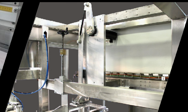
-Pressino automatico gestito da brushless atto a pressare le falde inferiori del cartone per garantire la chiusura perfetta -Prensa automática com movimentação brushless para pressionar as abas inferiores da caixa e garantir um fecho de caixa perfeito
