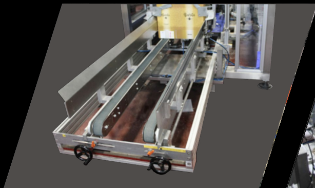
-Magazzino cartoni motorizzato fino a 200 cartoni -Armazém motorizado com capacidade até 200 caixas
