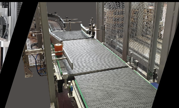
-Movimentazione cartoni tramite tappeto modulare brushless -Movimentação caixas através transportador brushless
