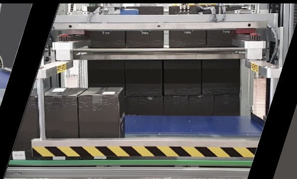
-Millennium 3.000 Evo con singolo braccio spintore fino a 1.300c/h Patented -Millennium 3.000 Evo com braço empurador singular produção até 1.300 cx/h Patenteado
