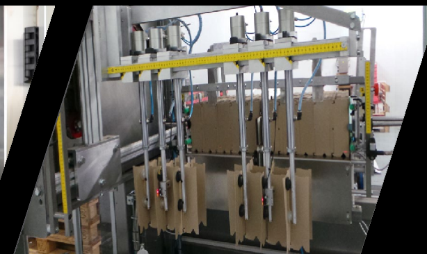
-Ins Alv 2T fino a 2.000 c/h -Ins Alv 2 T Produção até 2.000 cx/h
