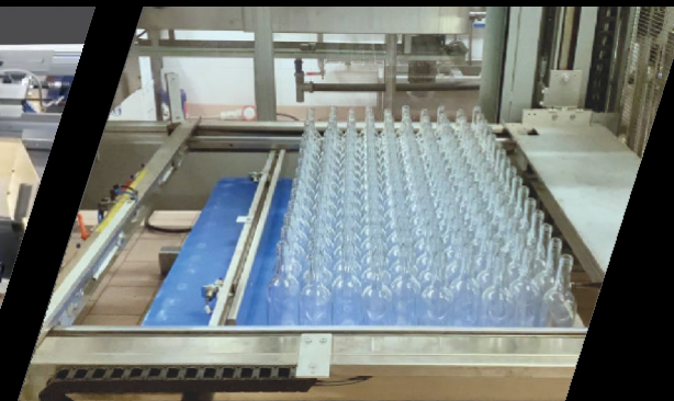
-Centratore perimetrale per compattare lo strato -Centrador perimetral para compactação do estrato
